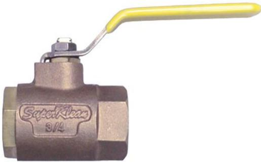
Mit dem neuen 3/4" Kugelhahn von SuperKlean kann der Anwender mit einer einzigen Hebelbetätigung die Zufuhr aus den Wasser-/Dampfleitungen schließen. Aufgrund der Ausführung in Bronze und rostfreiem Stahl kann dieser Kugelhahn entweder mit Wasser, Öl, Gas oder Dampf eingesetzt werden. Alle Komponenten aus rostfreiem Stahl stammen zur Verhinderung von Korrosion aus der 300-Serie Rostfrei. Unser 3/4" Kugelhahn ist der am häufigsten verwendete Hahn der Branche.
