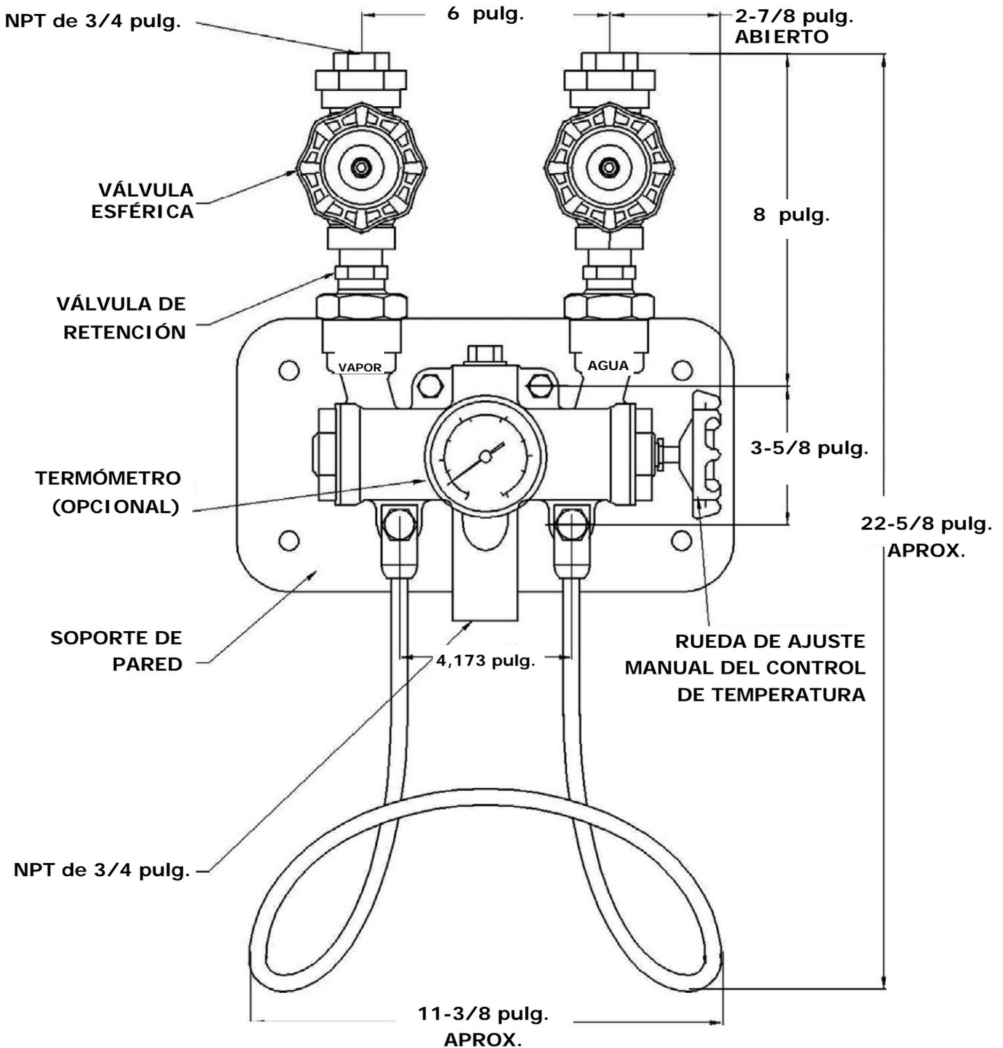
**ESQUEMA LATERAL DEL SISTEMA DURAMIX**
